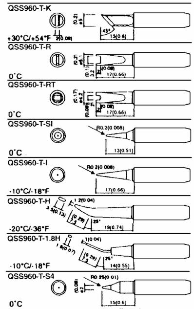
Диаметр хвостовика  $\varnothing 6.5$  мм
